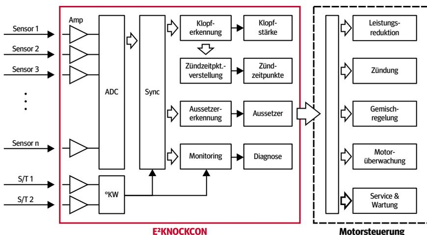
E<sup>2</sup>KNOCKCON-M berechnet arbeitsspiel-synchron Klopfstärken, Zündzeitpunkte und Zündaussetzer für jeden Zylinder. Diese Daten werden synchron zur Motorsteuerung übertragen, wo sie für verschiedene Zwecke verwendet werden können.
